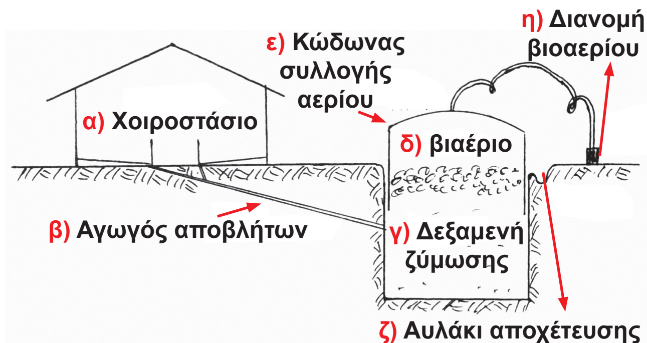
Εικόνα 9-6. Σχηματική απεικόνιση παραγωγής βιοαερίου.
