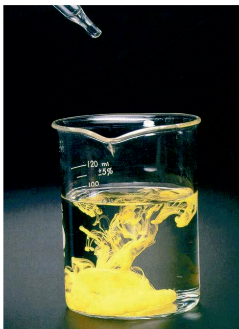
ΣΧΗΜΑ 5.22 Σχηματισμός ιζήματος \text{PbI}_2 κατά την ανάμιξη διαλύματος \text{Pb}(\text{NO}_3)_2 με διάλυμα \text{KI} .
