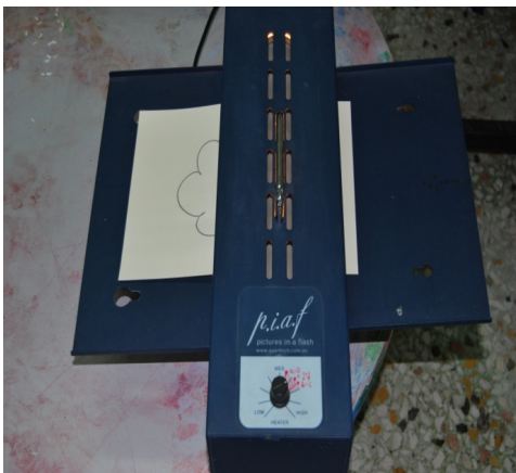
Στ. 5 Η μηχανή θερμαίνει το σχέδιο
