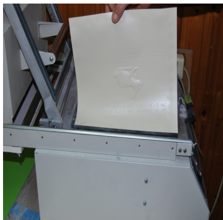
Στ. 5 Αφαιρούμε το πλαστικό με την ανάγλυφη εικόνα
